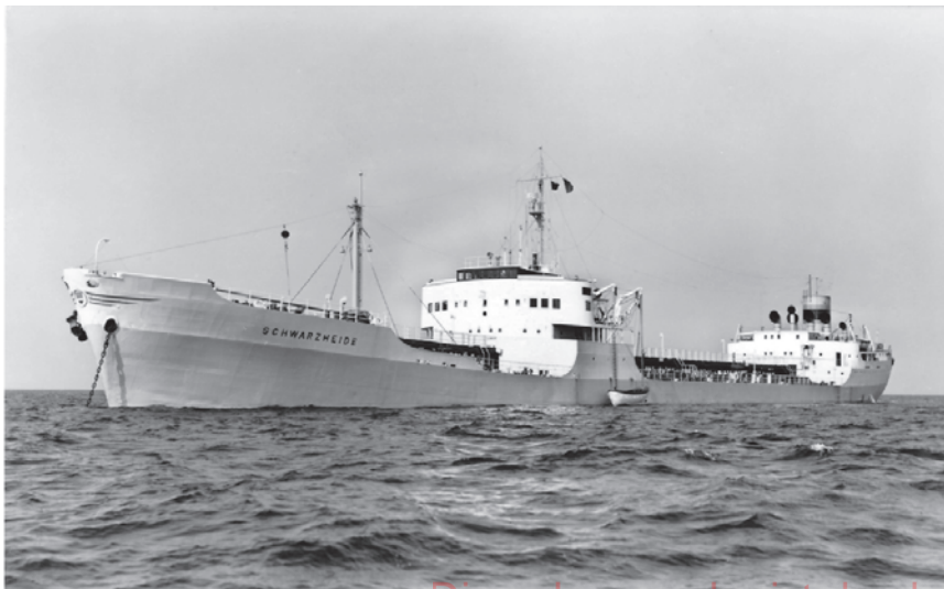
Der Alttonnage-Tanker „Schwarzheide“ wurde 1947 in Malmö gebaut. Er besaß eine Tragfähigkeit von 13.625 tdw und durfte 1967 nur noch bis Windstärke 6 in See gehen.
